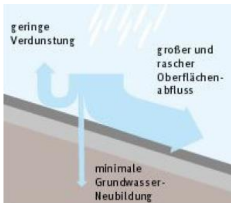
Abbildung 12 Wasserhaushalt bei befestigten Flächen 36
